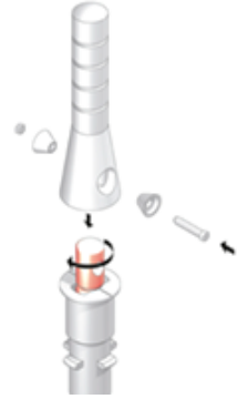
UUSI LIITOSKAPPALE ASENNETAAN
