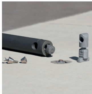
Pollarin liitoskappale on katkennut. Liitoskappaleen vaihto kestää muutamien minuutin
