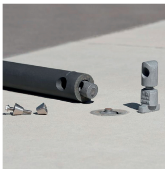
Pollarin liituskappale on katkennut. Liituskappaleen vaihto kestää muutamien minuuttien.
